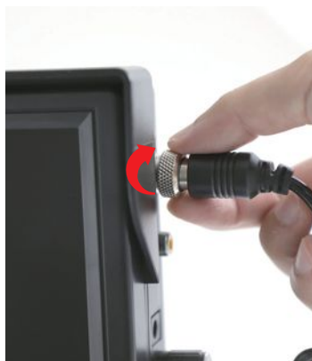
ケーブルの接続端子のネジを回して固定します
