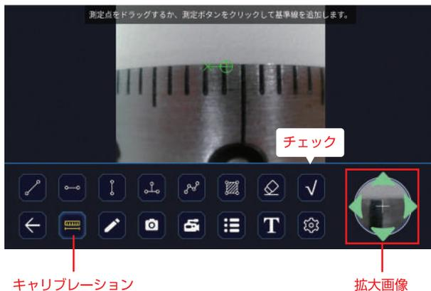
2. 参照寸法を入力するように求められますので、既知の長さを入力してください。単位はmmで、数値のみ入力し、OKをタップしてください。
