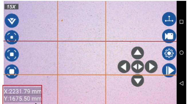
X軸、Y軸の平行線間距離表示
