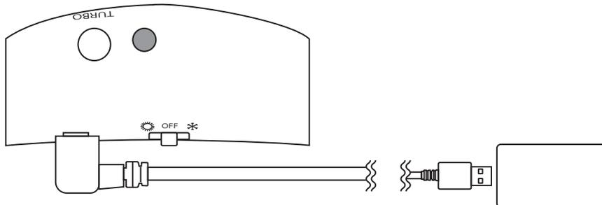
2. 【クーラー時】電源スイッチをクーラー側へスライドするとクーラーモードがONになります。
