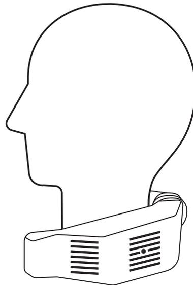
4. 使用後は首から製品を外し、電源スイッチをOFFの位置にスライドしてケーブルを抜いた状態で保管してください。
