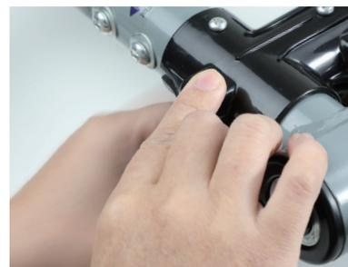
2. 両脚をシール(ラベル)の展開する方に回転させ製品を立たせます。
