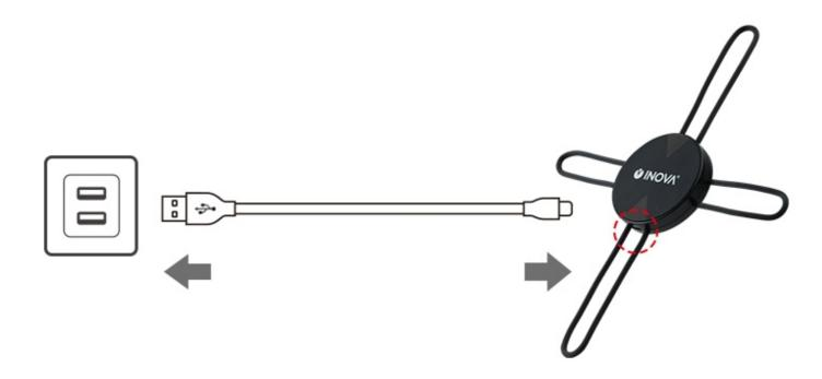
本製品の電源が入るとLEDの赤と青が同時に3回点滅します。
